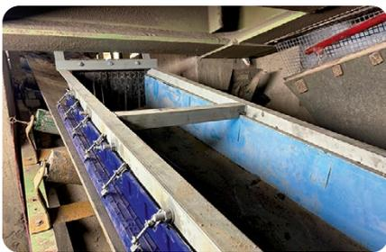
Transferencia del transportador con AirScrape® y K-Containment® Seal instalado.
