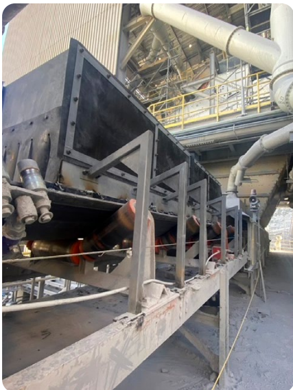
Das DustScrape-System besteht aus einem Filtertuch, Stützbögen und Schürzen, Armen, die das System über dem Band halten, und einem Gummivorhang, der eine weitere Staubentwicklung verhindert.
