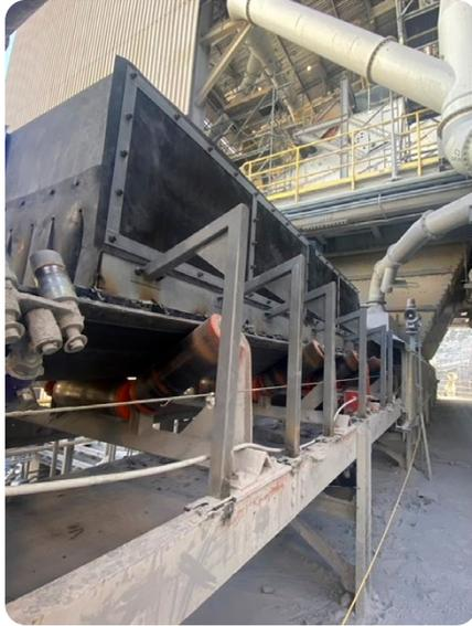
El sistema DustScrape consta de una tela filtrante, arcos y delantales de soporte, brazos que sujetan el sistema por encima de la cinta y una cortina de goma que impide que se siga formando polvo.
