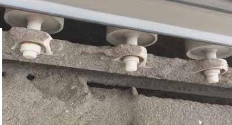
**SEITENABDICHTUNG MIT MAXIMALEFFEKT:** Auf Basis des Luft von außen ansaugenden Venturi-Effekts arbeitet der Airscrape kontakt- und damit verschleißfrei, schont den Gurt und beseitigt zuverlässig Staubaustritte und Verschüttung selbst bei feucht-klebrigem Material, wie links nach der Umrüstung zu erkennen ist. Fotos: Scrapetec
